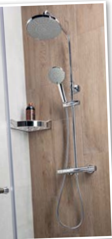
SL533 LIGA teleskopický sprchový sloup s termostatickou baterií výška 710–1280 mm rozteč 150 mm, chrom
